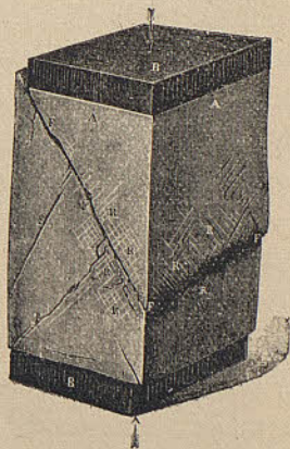
Fig. 37. — Bloque de cera, sometido a la acción de la prensa hidráulica. — Daubré, obra citada.
