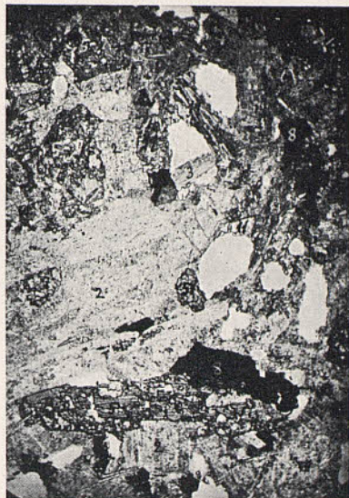
Fig. 34. — Ofita de La Torre (Arcos de las Salinas). L. ord. 10 d. 2 feldespato alterado, 3 biotita, 5 augita, 7 clorita, 11 preenita
