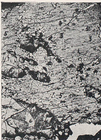
Fig. 11. — Peridotita escoriácea, I. ord. 10 d. Grandes placas de augita 5 con incrustaciones de biotita 3 y olivino 6 y magnetita 3
