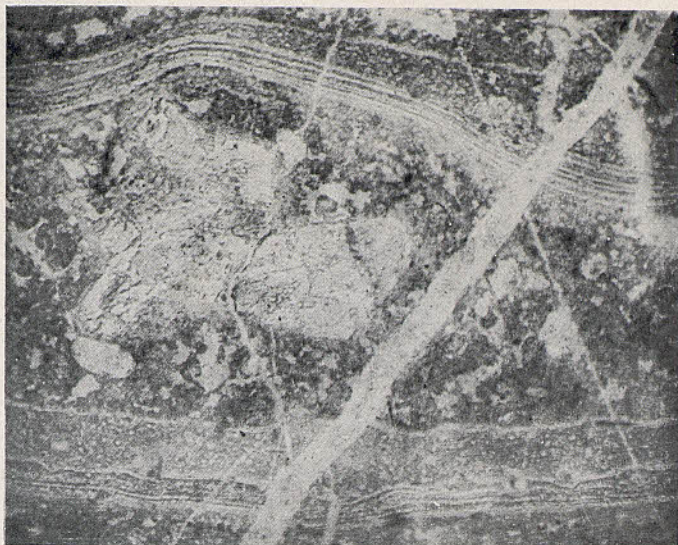
Fig. 1. — Riolita zonal, Greixa. L. ord. 25 d. Fenocristales corroïdos de cuarzo y de feldespato sobre base en bandas vitrofidica fluidal con microlitofisas rellenas de cuarzo secundario
