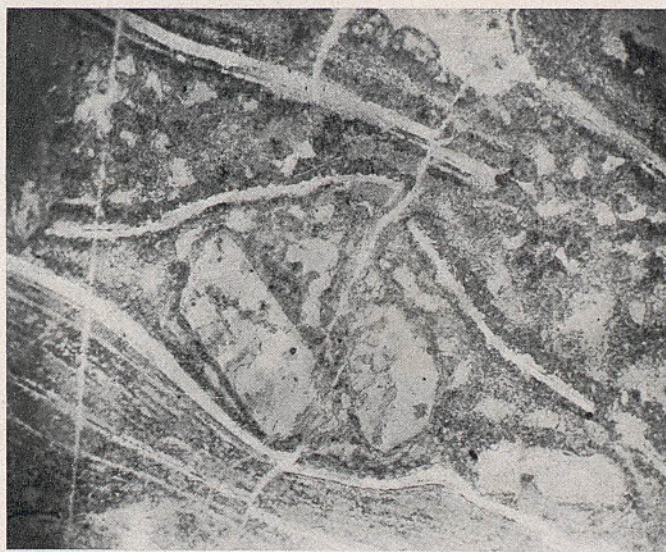
Fig. 2. — Igual roca, L. ord. 25 d. Fenocristales de cuarzo, base fluidal zonar, con grietas y microfallas
